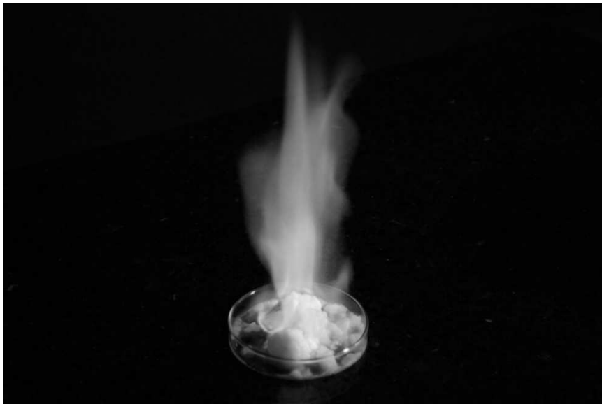
メタンハイドレート(人工) 燃焼写真
